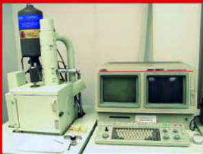
Figura 16. Microscopio electrónico de barrido (SEM) con EDAX y EBIC
