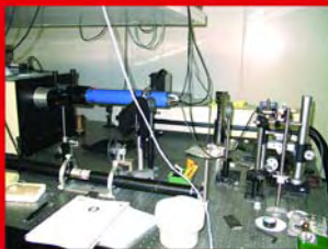
Figura 17. Microscopio de fuerzas atómicas (AFM)
