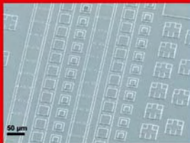
Figura 19. Imagen de SEM de una matriz de detectores de IR (píxeles) para la fabricación de una cámara de visión nocturna en la región de 3 a 5 \mu\text{m}
