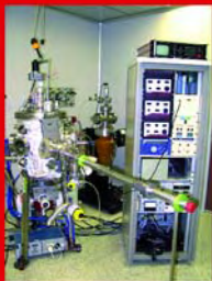
Figura 9. Reactor de crecimiento por pulverización catódica ("sputtering") dedicado al crecimiento de materiales magnéticos
